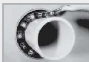
Strângeți fiecare șurub câte o tură și repetați operațiunea în cerc până când toate modulele sunt strânse uniform
