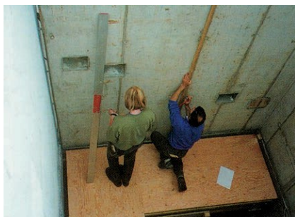
Măsurători cu șnur și riglă de măsurat
